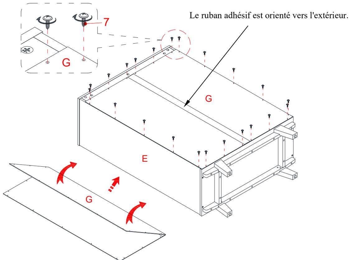
12. Maintenant, revenez et serrez solidement tous les boulons et vis. Assurez-vous que toutes les pièces sont bien serrées et qu'il n'y a pas d'espace entre les pièces. Cela permettra de maintenir l'unité à l'équerre.
