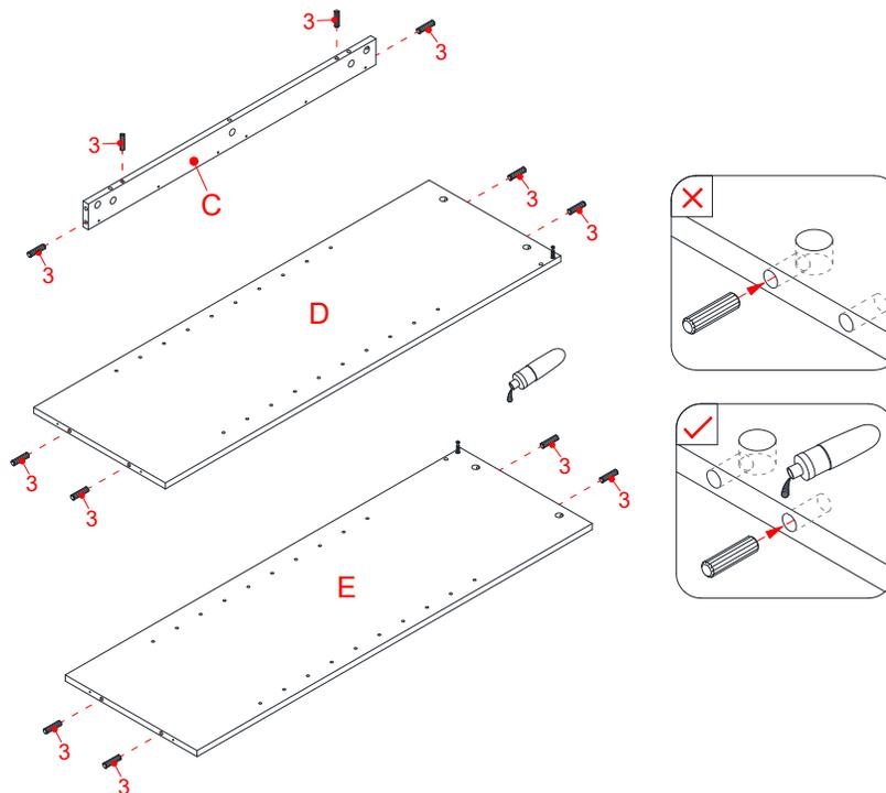
3. Collez douze Chevilles à bois (3) de 30 mm dans les trous intérieurs de la Civière arrière supérieure (C) et des Panneaux latéraux (D et E). Veillez à utiliser une petite quantité de colle pour les deux extrémités de tous les goujons.
