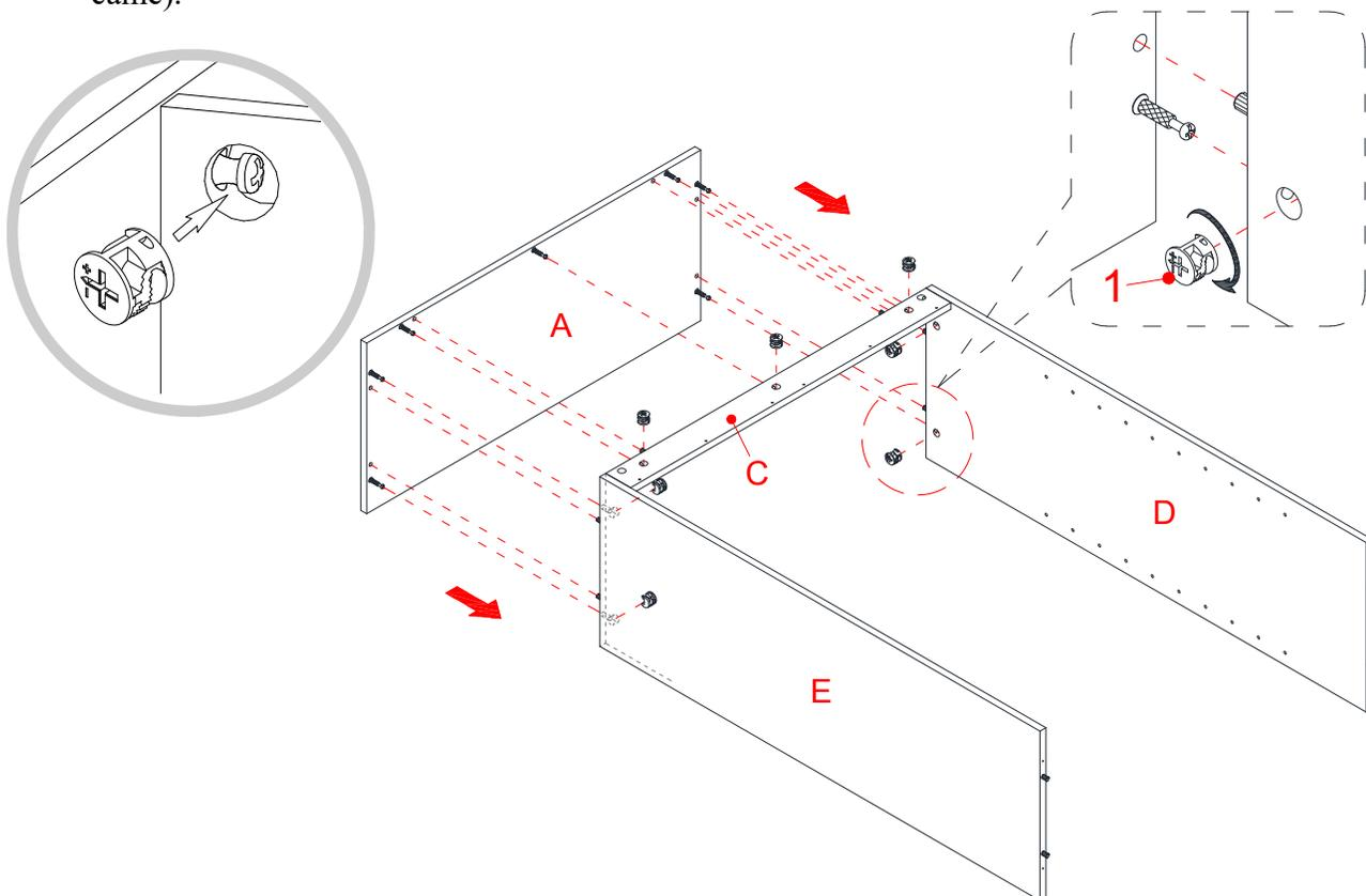
5. Aligned et fixez le Panneau supérieur (A) à la Civière arrière supérieure (C) assemblé et aux Panneaux latéraux (D et E) en engageant sept Verrous à came (1).
