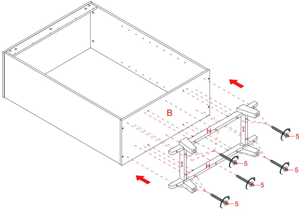
11. En utilisant les chevilles en bois comme guide, alignez et fixez les Civières de base (H et I) assemblés au Panneau inférieur (B) et serrez-les avec quatorze Vis (5) de 38 mm.
