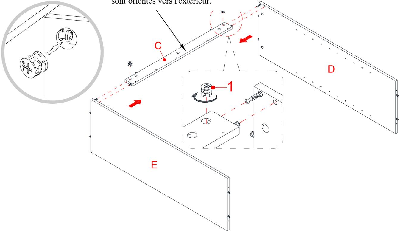
4. Aligned et fixez la Civière arrière supérieure (C) entre les Panneaux latéraux (D et E) en engageant deux Verrous à came (1). (Voir la page 3 sur le supplément de fonctionnement du Système de verrouillage à came).
