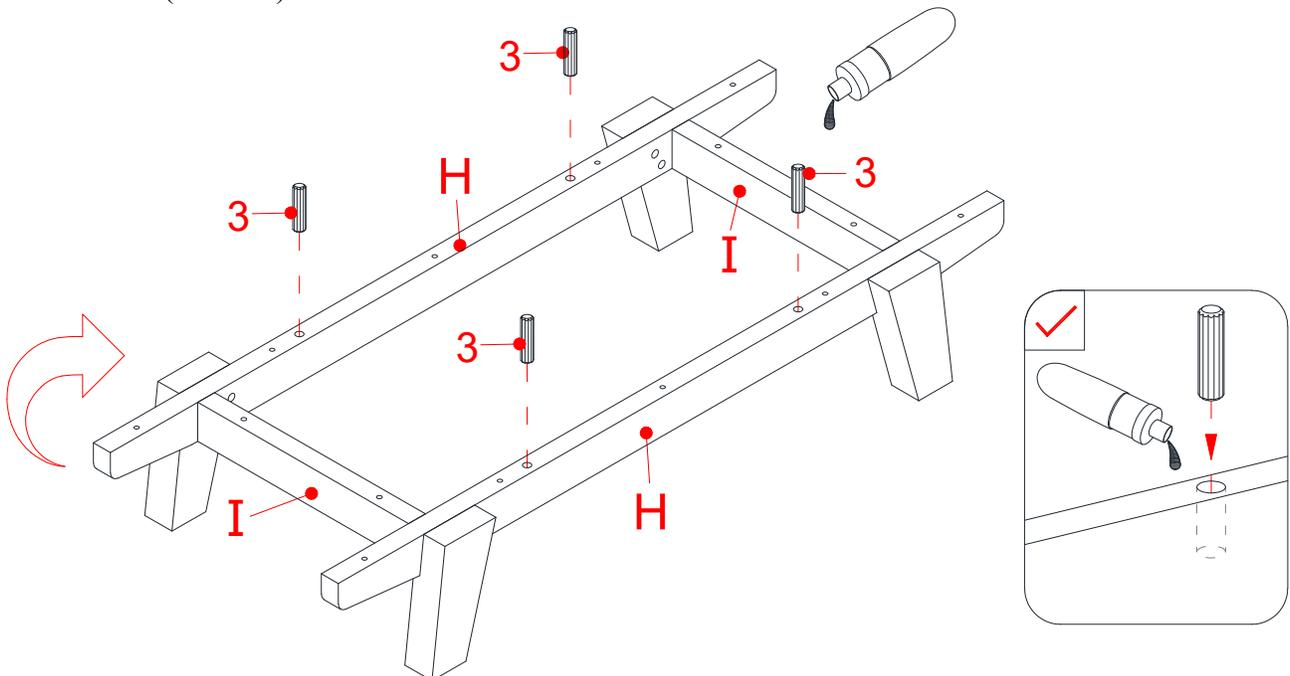
10. Mettez la base assemblée en position verticale et collez quatre Chevilles en bois (3) de 30 mm dans les trous intérieurs des Civières de base (H et I).
