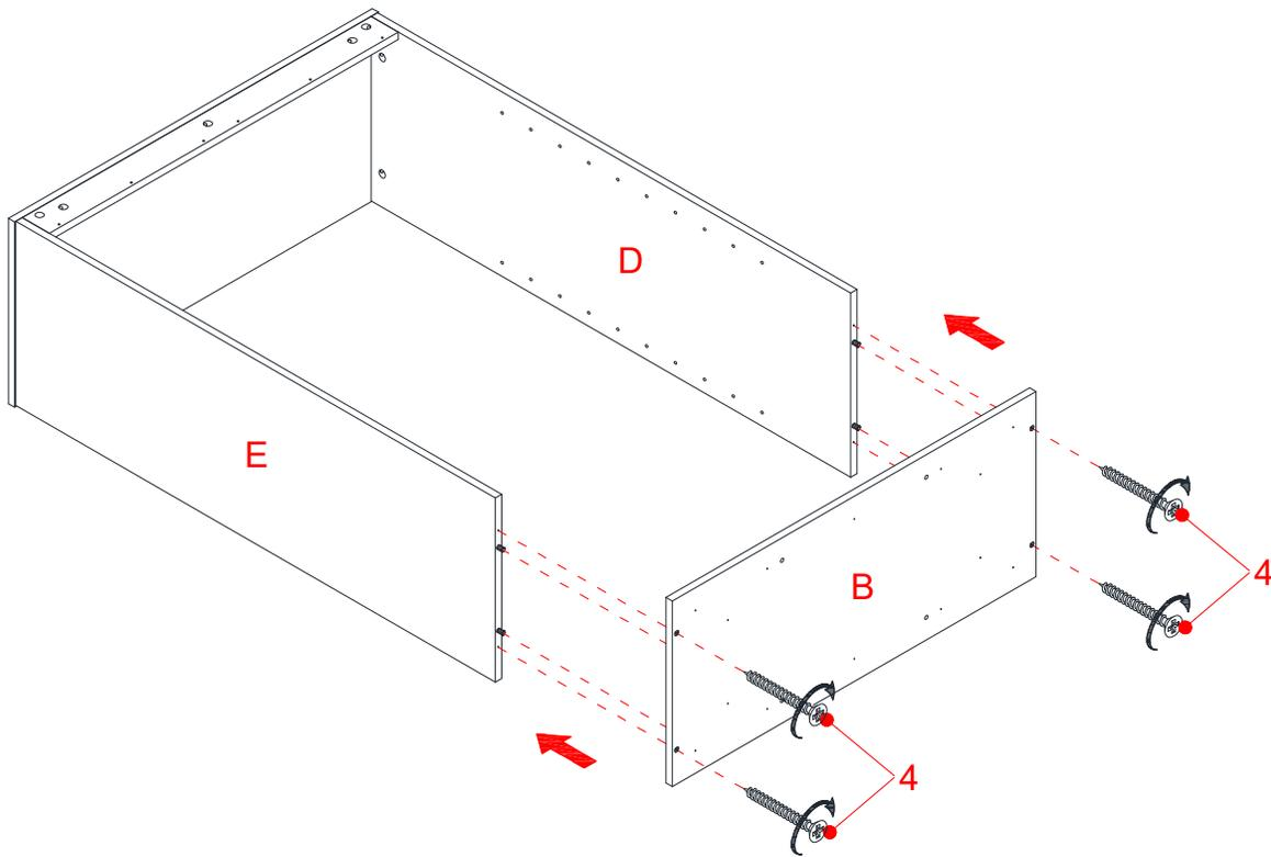
6. En utilisant les chevilles à bois comme guide, alignez et fixez le Panneau inférieur (B) aux Panneaux latéraux assemblés (D et E) à l'aide de quatre Vis (4) de 50 mm. Serrez les vis avec un tournevis Phillips.
