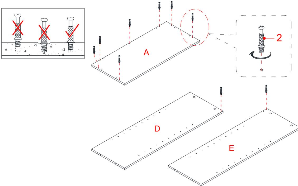
**REMARQUE:** Veuillez ne pas complètement serrer les boulons avant d'avoir fini le montage de toutes les pièces. Une fois assemblées, revenez en arrière et serrez tous les boulons. Cela facilitera l'assemblage.
