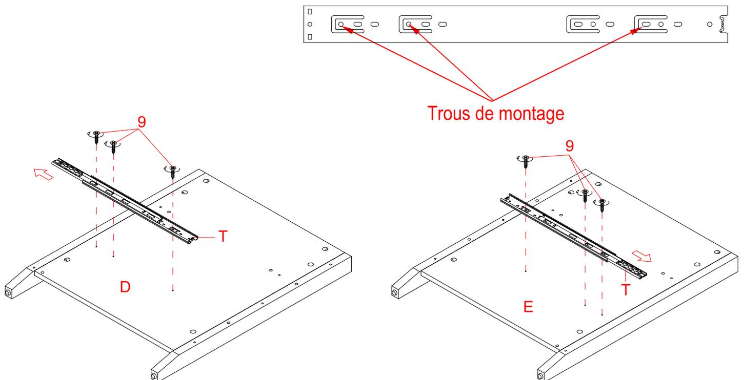
19. En vous servant des trous de guidage, fixez les glissières séparées (T) aux panneaux (D et E) respectivement en utilisant trois vis de 1/2 po (9) par glissière.
