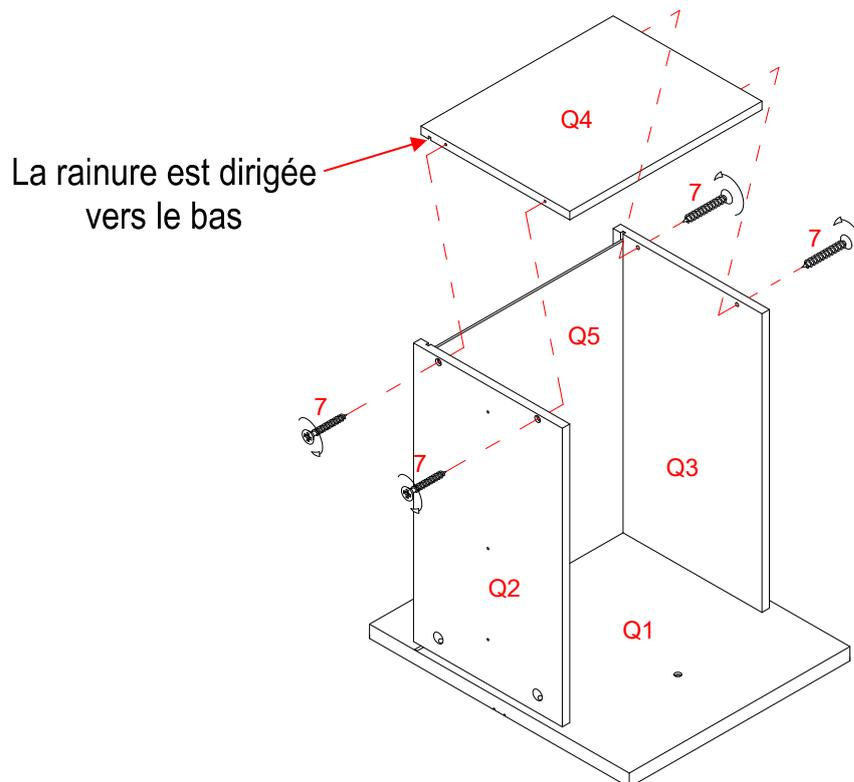
11. Fixez le panneau arrière du tiroir (Q4) aux panneaux latéraux du tiroir (Q2 et Q3) en utilisant quatre vis de 32 mm (7). Assurez-vous que le panneau inférieur du tiroir (Q5) est bien inséré dans la rainure du panneau arrière du tiroir (Q4).
