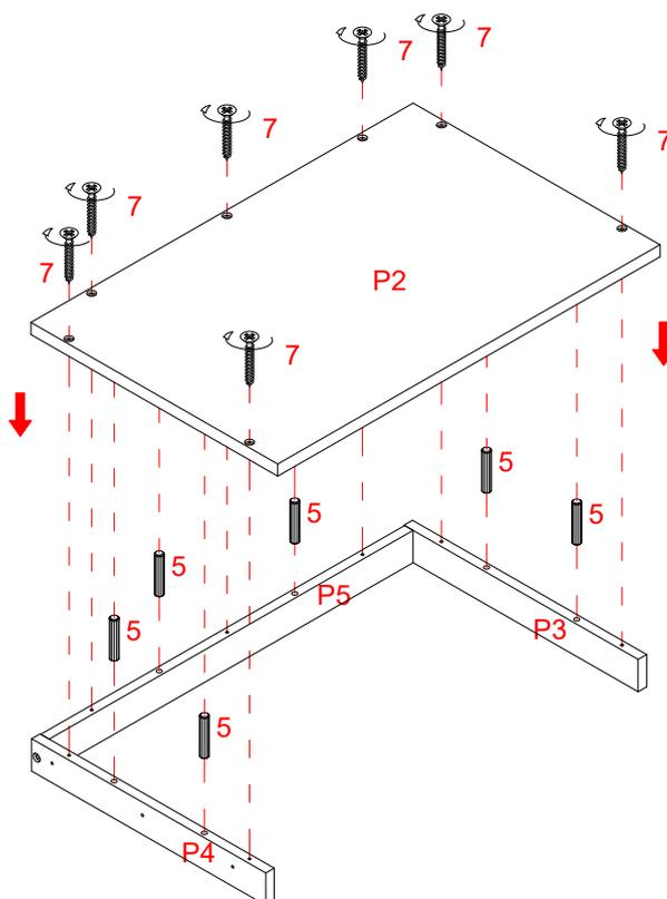
3. Fixez le panneau inférieur du tiroir central (P2) au les panneaux latéraux du tiroir central (P3 et P4) et au le panneau arrière du tiroir central (P5) avec six goujons en bois de 30 mm (5) et sept vis de 32 mm (7). Utilisez une petite quantité de colle sur les deux extrémités de tous les goujons.
