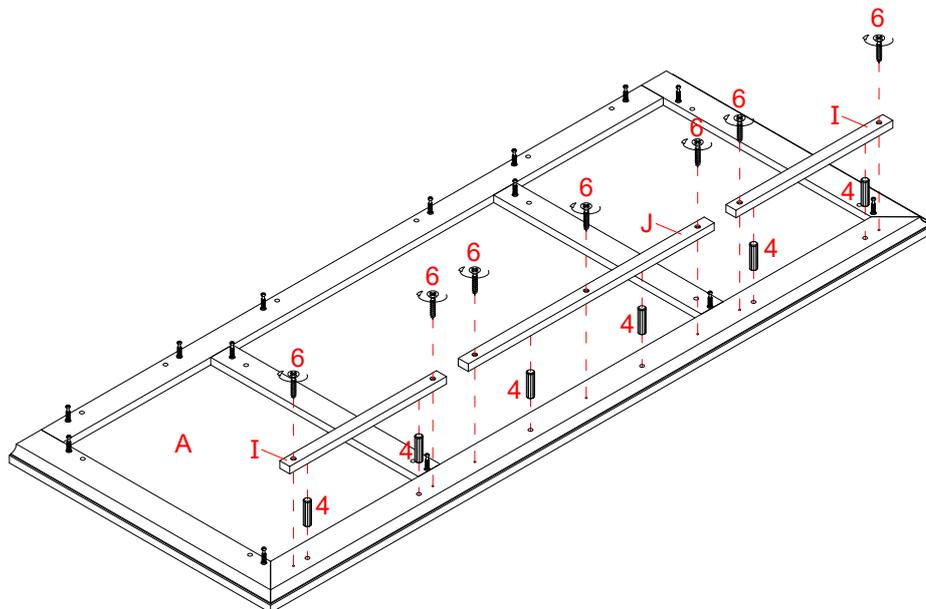
21. Fixez les entretoises supérieures (I et J) au dessus de bureau (C) en utilisant six goujons de bois M8 x 30 mm (4) et sept vis de 25 mm (6).
