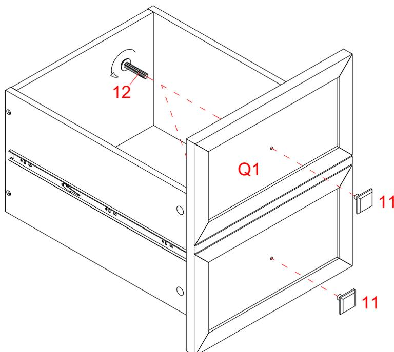
14. Mettez le tiroir assemblé debout. Fixez deux poignées (11) à l'extérieur du devant du tiroir (Q1) en utilisant les deux boulons de poignée (12).
