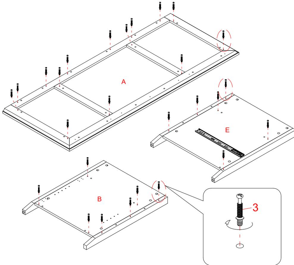
20. Vissez fermement les boulons à came (3) dans les petits trous des panneaux (A, B et E).
