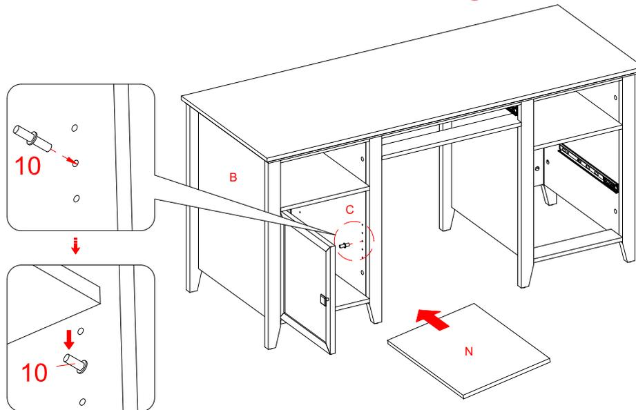
40. Insérez les taquets de tablette (10) dans les trous désirés des côtés du compartiment. Assurez-vous que vous placez les quatre taquets de tablette au même niveau pour éviter que la tablette soit inclinée. Inclinez et déposez la tablette ajustable (N) sur les taquets (10).
