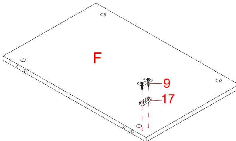
25. En suivant les trous de guidage comme référence, fixez l'arrêt de porte (17) au bas de la tablette fixe (F) à l'aide de 2 vis M3.5 x 12 mm (9).
