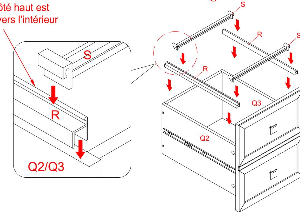
15. Placez les rails guides (R) sur les côtés gauche et droit du tiroir (Q2 et Q3) en dirigeant le côté haut vers l'intérieur.
