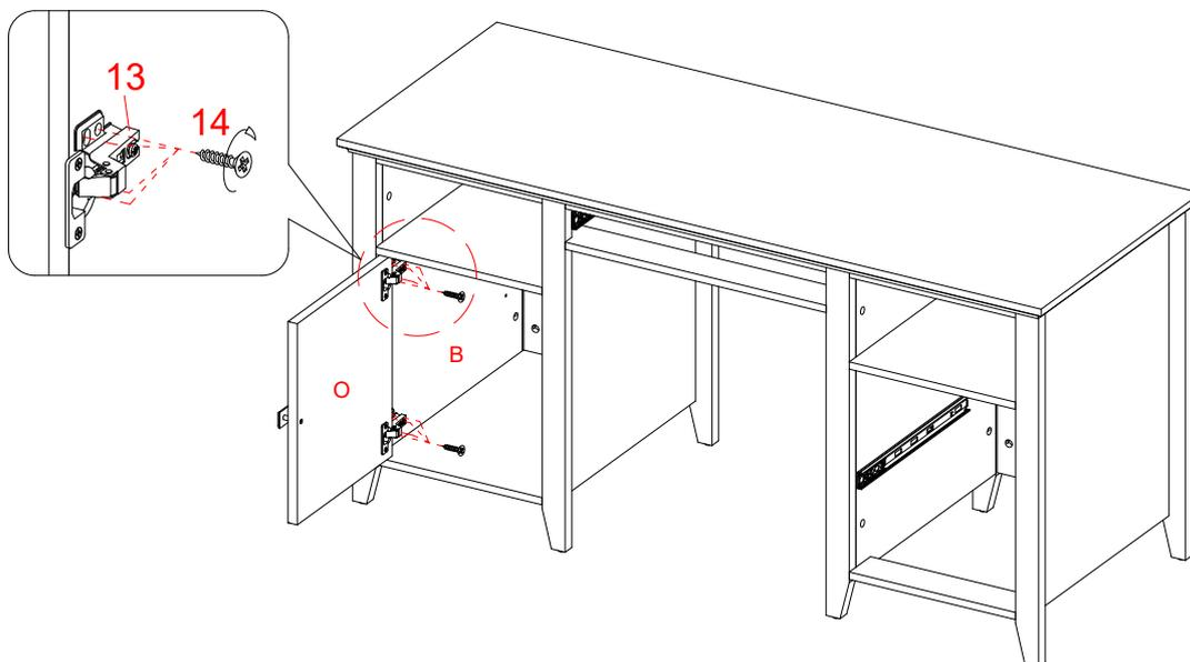
38. En utilisant les trous de guidage, prenez la porte (O) et fixez les bases de charnière au panneau latéral gauche (B) en utilisant quatre vis en zinc (14) pour chacune.
