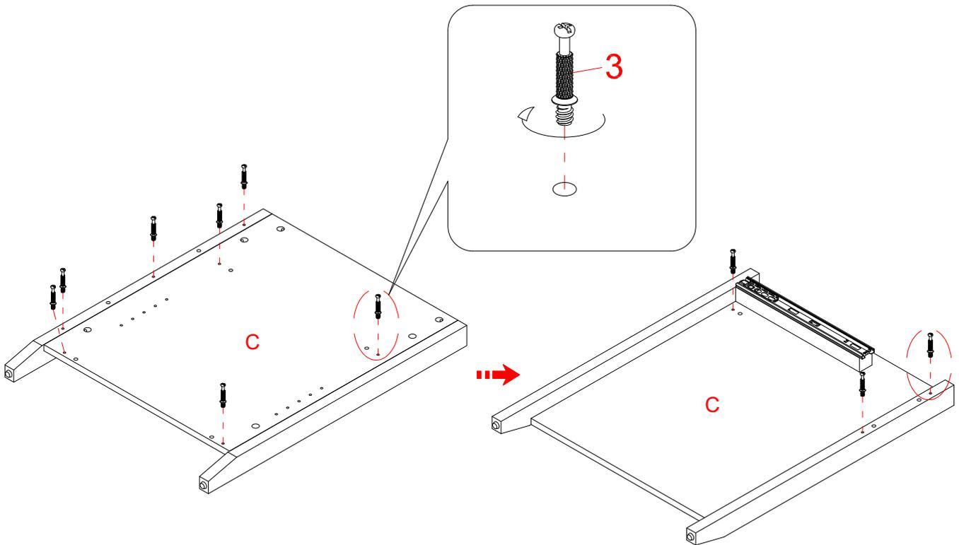
22. Vissez fermement les boulons à came (3) dans les petits trous du panneau de division gauche (C) aux deux extrémités.
