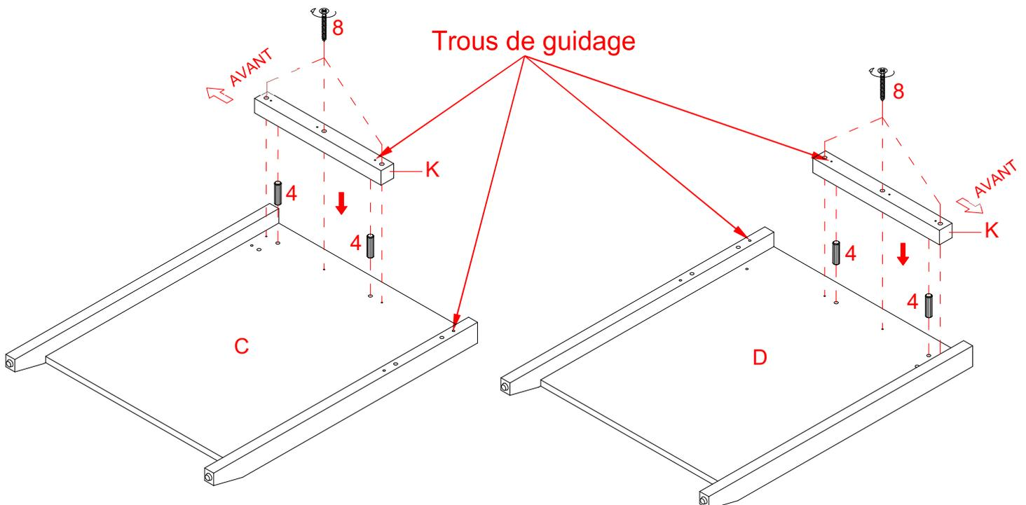
17. En utilisant les trous de guidage, fixez les supports de coulisse (K) aux panneaux de division (C et D) en utilisant deux goujons de bois M8 x 30 mm (4) et trois vis de 38 mm (8) par support.
