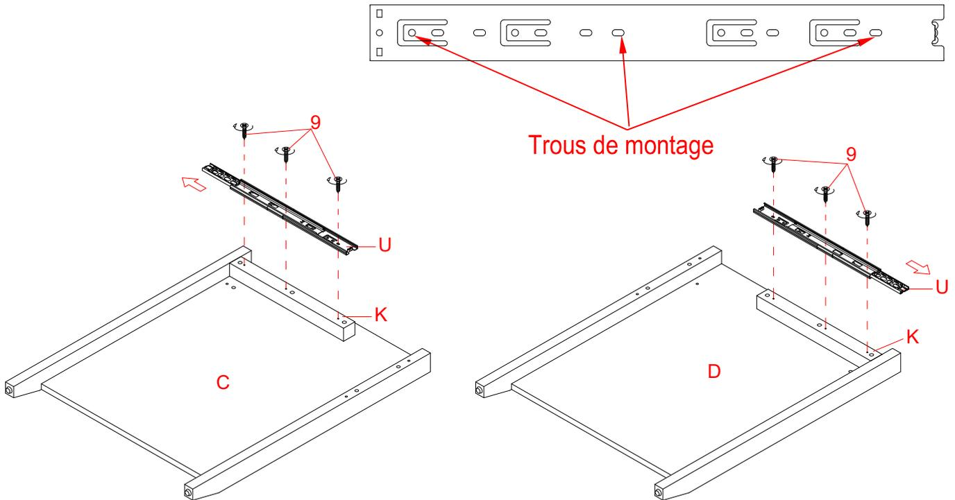
18. En vous servant des trous de guidage, fixez les glissières de 14 po séparées (U) aux supports de coulisse (K) en utilisant trois vis de 1/2 po (9) par glissière.
