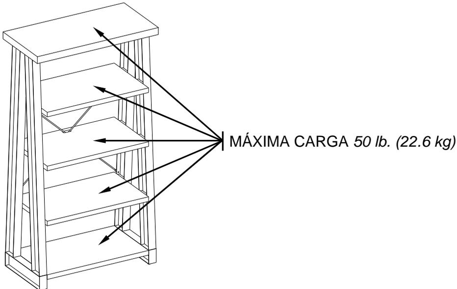
**⚠ ADVERTENCIA** ESTA UNIDAD DEBE UTILIZARSE CON LOS PRODUCTOS ADECUADOS Y PESOS MAXIMOS INDICADOS. SI SE UTILIZAN OTROS PRODUCTOS O SE EXEDE EL PESO MAXIMO, PODRIA RESULTAR EN UNA INESTABILIDAD DE LA UNIDAD CAUSANDO POSIBLES LESIONES.
