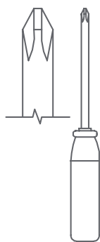
Tournevis à tête cruciforme n° 2 Taille réelle de la tête
